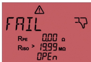
Obr. 47: Neúspěšné měření. Na displeji se zobrazí „OPEN“. Přerušeni spojení vodiče/otevřený spínač
