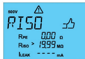
Obr. 20: Úspěšně absolvovaná zkouška izolace
