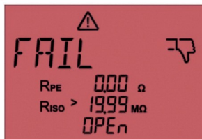
Obr. 47: Neúspěšné měření. Na displeji se zobrazí „OPEN“. Přerušení spojení vodiče/otevřený spínač
