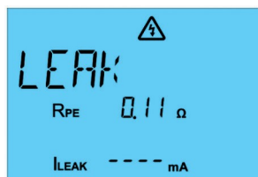
Obr. 59: Měření proudu ochranného vodiče u třífázového zařízení
