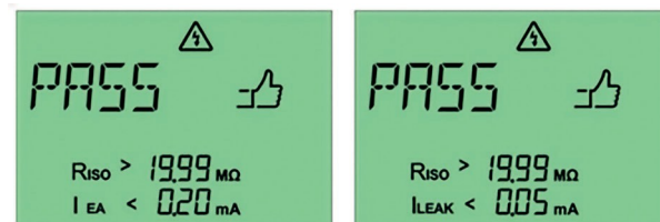
Obr. 36: Úspěšné měření alternativní metodou svodového proudu (vlevo) a metodou diferenciálního proudu (vpravo) u zařízení s krytím II
