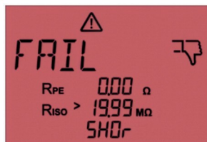
Obr. 48: Neúspěšné měření. Na displeji se zobrazí „SHOr“. Zkrat mezi L a N
