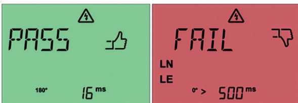
Obr. 53: Úspěšné měření RCD (vlevo) a neúspěšné měření (vpravo)
