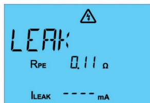
Obr. 59: Měření proudu ochranného vodiče v třífázovém zařízení
