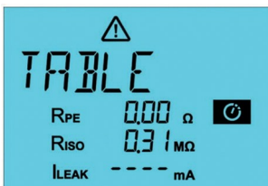
Obr. 21: Měření přerušeno; zkontrolujte naměřenou hodnotu a případně pokračujte v měření nebo přerušit
