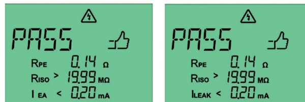
Obr. 26: Úspěšné měření alternativní metodou svodového proudu (vlevo) a metodou diferenciálního proudu (vpravo) pro zařízení s krytím I
