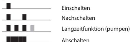
Der zusätzliche Steuereingang C1-C2 ermöglicht im Modus T und TW die Ansteuerung des Treppenlichtautomaten durch eine Spannung von 8 bis 230V a.c./d.c. . Über diesen Eingang lässt sich der Zeitablauf starten und nachschalten. Das Abschalten (Energiesparfunktion) und die Programmierung längerer Zeiten (pumpen) ist über diesen Eingang nicht möglich.
