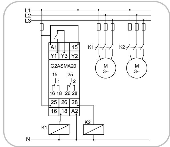
➤ Ansteuerung durch die Versorgungsspannung
