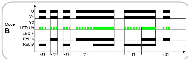
Der Eingang Parallelbetrieb (Brücke Y2-Y3) hat die höchste Priorität, und führt unter Berücksichtigung des Schaltversatzes immer zur Aktivierung beider Ausgangsrelais. Dabei wird ein Fehler angezeigt (LED), wenn der Eingang Parallelbetrieb (Brücke Y2-Y3) im Modus A ohne anstehender Betriebsanforderung (Brücke Y1-Y3) aktiviert wird. Im Modus B führt die Aktivierung des Einganges Parallelbetrieb (Brücke Y2-Y3) immer zur Fehler-Anzeige.
