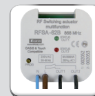
RFSA-62B dvoukanálový multifunkční spínací aktor 2 x spínací 8A 6 funkcí, 230V AC
