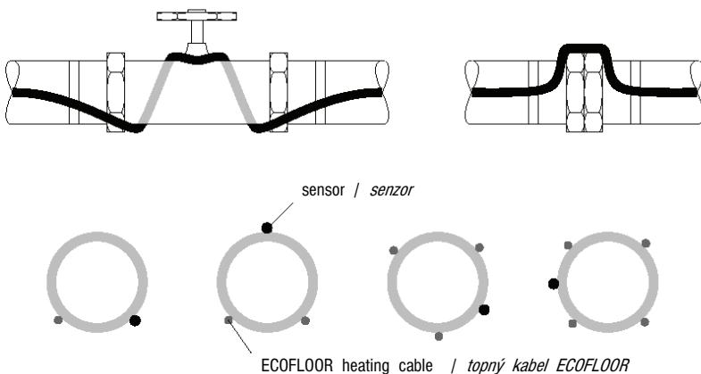
AFFIXING THE CABLE TO THE PIPE / UPEVNĚNÍ KABELU
