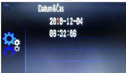
Zobrazí se obrazovka pro zadání času, tlačítky se nastaví požadovaná hodnota, potvrzení číslice se provede tlačítkem , čas uložíme tlačítkem
