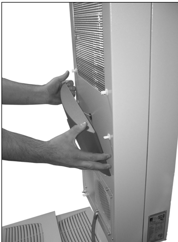
Obr. 37: Demontáž čelného modulu
