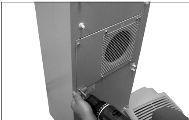
Obr. 63: Uvoľnenie štyroch skrutiek ventilátora vonkajšieho otvoru
