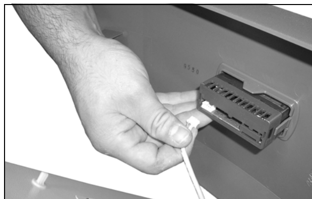
Obr. 60: Odpojenie kábla displeja
