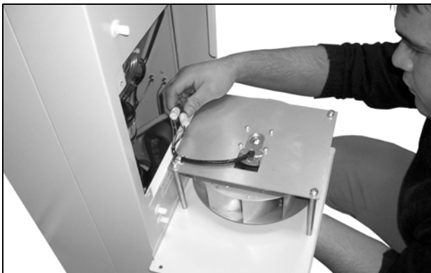
Obr. 65: Odpojenie konektorov ventilátora (1)
