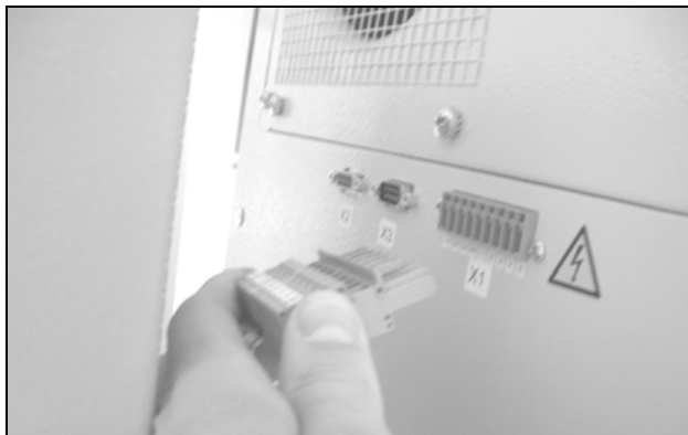
Obr. 53: Vytiahnutie sieťovej zástrčky
