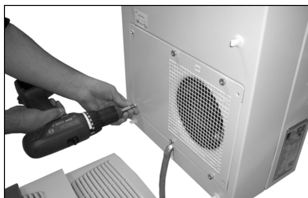
Obr. 41: Demontáž ventilátora vonkajšieho okruhu (uvoľnenie štyroch skrutiek)
