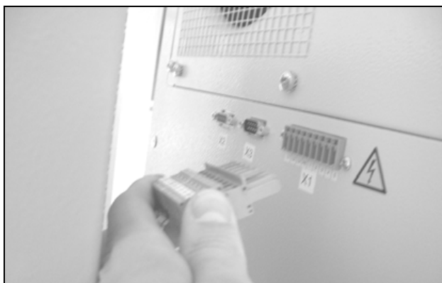
Obr. 34: Vytiahnutie sieťovej zástrčky
