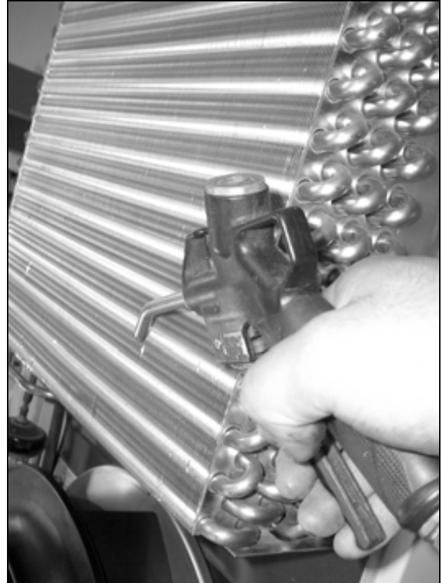
Obr. 51: Vyfúkanie telesa výmenníka tepla a priestoru kompresora stlačeným vzduchom (1)
