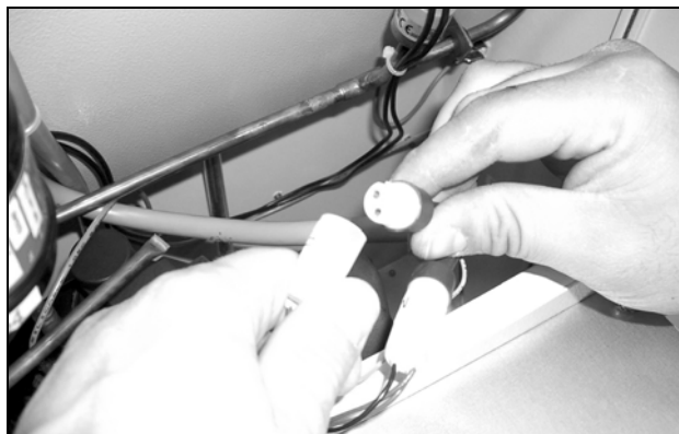
Obr. 67: Odpojenie konektorov ventilátora (3)
