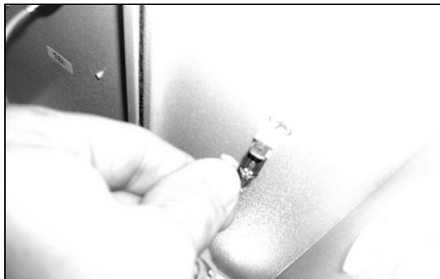
Obr. 69: Odpojenie zemniaceho kábla ventilátora (2)
