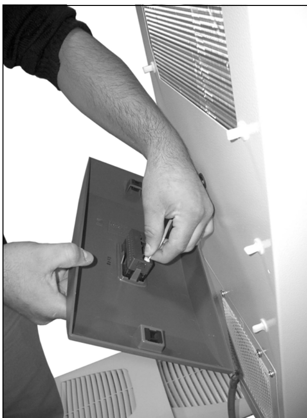
Obr. 38: Odpojenie konektora od displeja (1)
