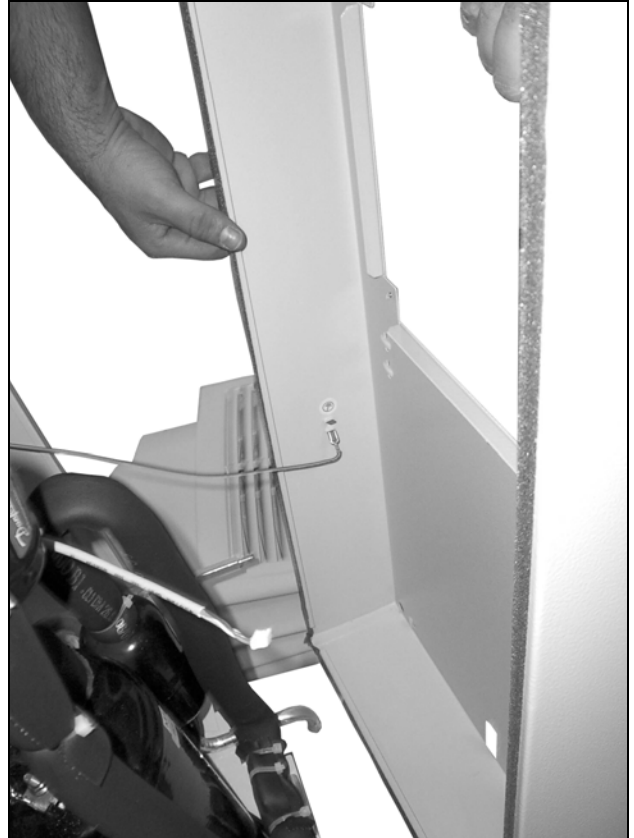
Obr. 72: Odpojenie zemniaceho kábla (1)
