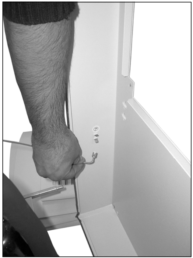
Obr. 73: Odpojenie zemniaceho kábla (2)
