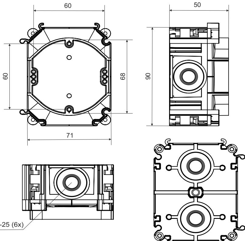
popis výrobku: přístrojová krabice do litých betonů- instalaci hloubka 50mm
