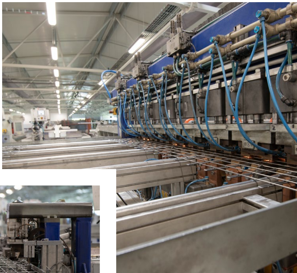
◀ ▶ Středofrekvenční svařovací centra pro svařování drátěné konstrukce žlabů MERKUR 2.
