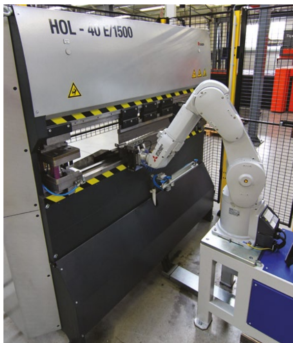
▶ Jedno z robotizovaných pracovišť výroby ohýbaných plechových prvků ve výrobním areálu ARKYS.
