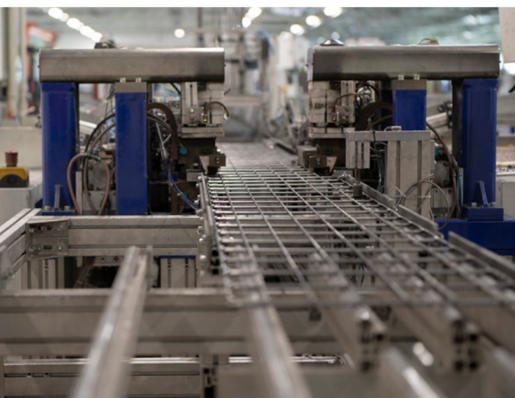
◀ ▶ Středofrekvenční svařovací centra pro svařování drátěné konstrukce žlabů MERKUR 2.
