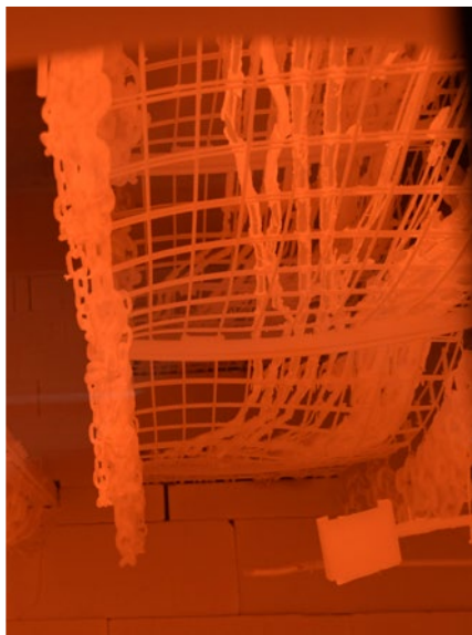
◀ Pohled na testované kabelové trasy ve zkušební komoře před a během zkoušky odolnosti při požáru.
