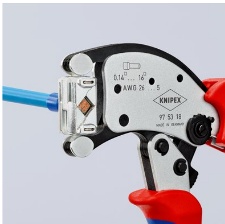
Jedinečná flexibilita: dutinky lze do otočné lisovací hlavy zavádět z téměř každé pozice
