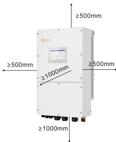
Obrázek 3.5 Montážní vůle měniče
